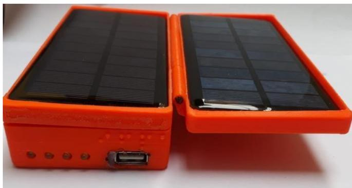
**Figura 5:** Protótipo do carregador SUNLOAD.
