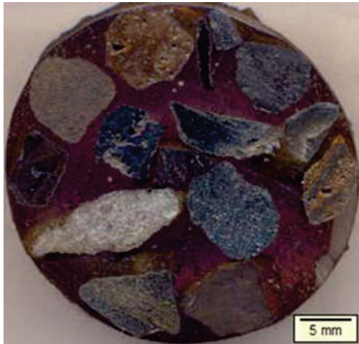
Figura 4. Feições morfológicas e tamanhos de grãos do concentrado de sinter feed .
