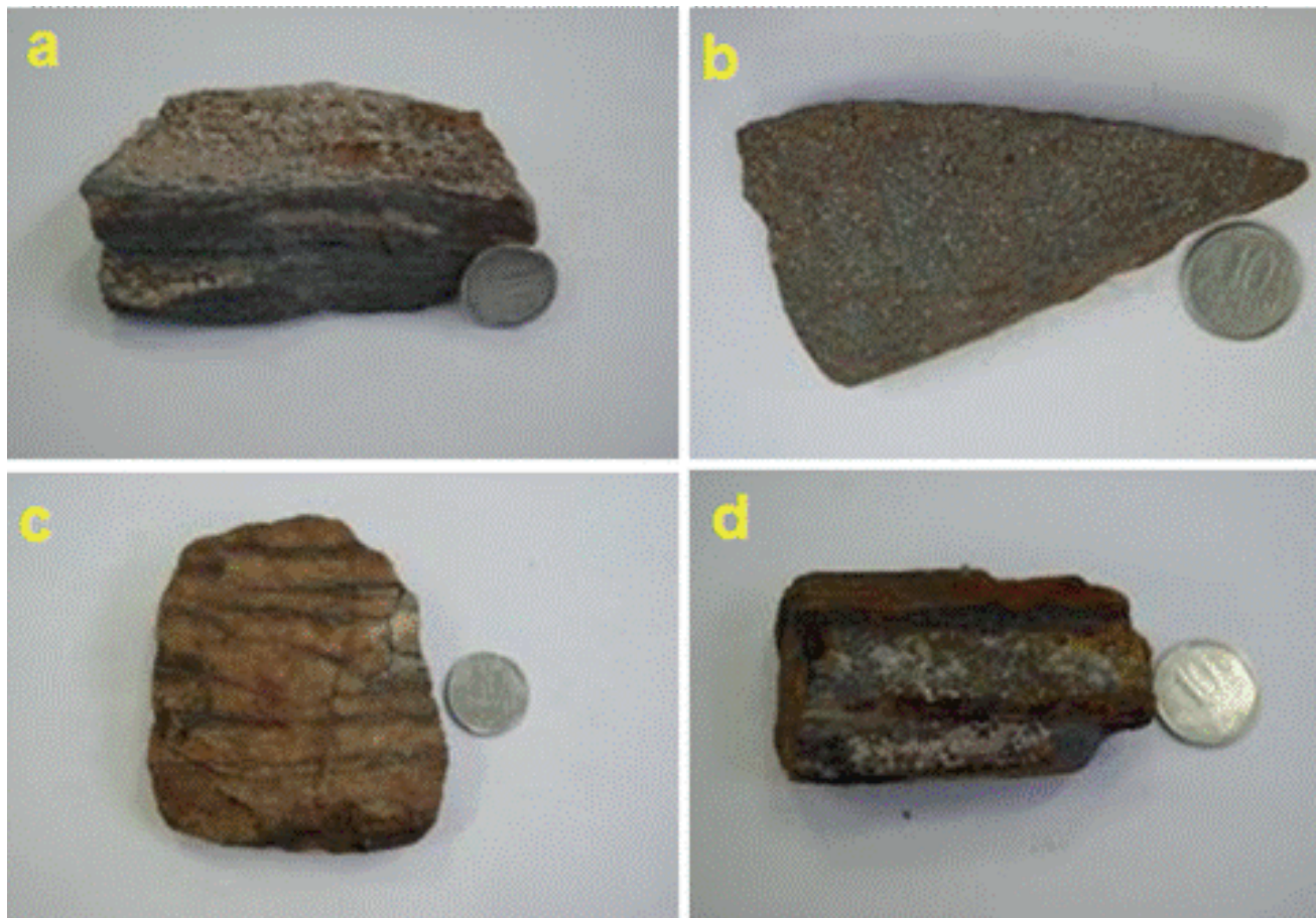
Figura 2. Amostras de ROM das três minas de Pedra Branca do Amapari. a) camadas ferro-silicáticas concordantes com o acamamento em tonalidades cinzento-esbranquecidas (PB1); b) especularita cinza metálico; c) camadas silicáticas e ferríferas discordantes com o acamamento na tonalidade cinza-escura; d) pontuações esbranquiçadas de quartzo em matriz silicática e bandas ferríferas (PB2).
