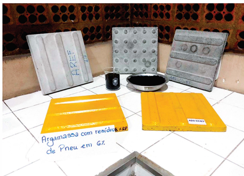
Figura 2 - Piso Podotátil de argamassas com resíduos de pneus.
